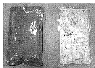
図2 透明なポリマーベースのパウチと標準的なアルミ箔ベースのレトルトパウチの比較
